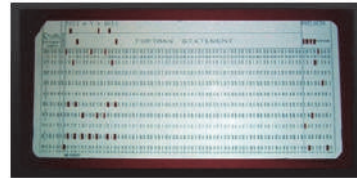
Οι πρώτοι ηλεκτρονικοί υπολογιστές- mainframes (~1950-1980) - Χωρίς οθόνη και με χρήση διάτρητης κάρτας ως μέσου εισαγωγής δεδομένων στον υπολογιστή.
