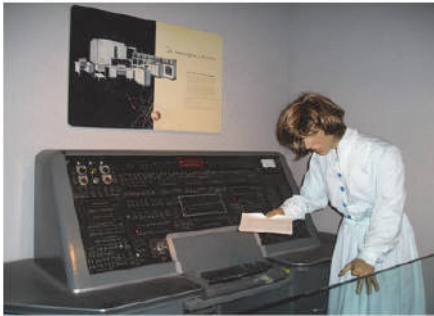
Οι πρώτοι ηλεκτρονικοί υπολογιστές- mainframes (~1950-1980) - Χωρίς οθόνη και με χρήση διάτρητης κάρτας ως μέσου εισαγωγής δεδομένων στον υπολογιστή.
