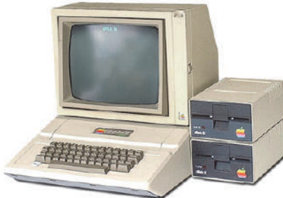
1980: Apple IIe με κεντρική μονάδα (RAM 64kB), ενσωματωμένο πληκτρολόγιο, οθόνη καθοδικής λυχνίας, εξωτερικές μονάδες δισκετών (164kB).
