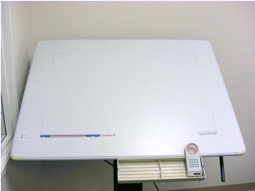
Σχήμα 2.2 Συσκευή σχεδίασης και ψηφιοποίησης χαρτών και τομών (digitiser)
