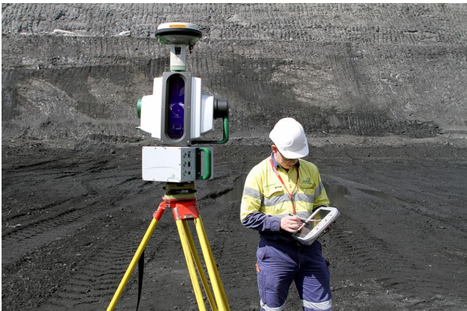
Σχήμα 2.6 Φορητός σαρωτής λέιζερ τρισδιάστατου ανάγλυφου κατά την αποτύπωση υπαίθριου ορυχείου (MarteK I-Site 8810)
