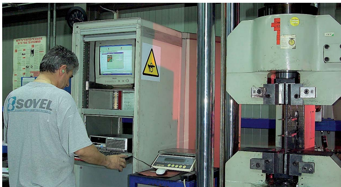
Σχήμα 2.10 Μηχανή μέτρησης ορίου διαρροής και αντοχής σε εφελκυσμό
