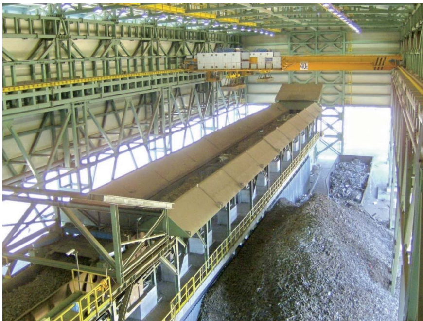
Σχήμα 2.1 Φωτογραφία συνεχούς τροφοδοσίας scrap
