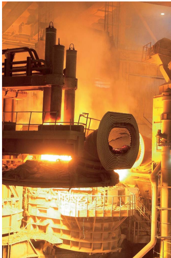
Σχήμα 2.2 Ηλεκτρικός κλίβανος τόξου (Electric Arc Furnace)
