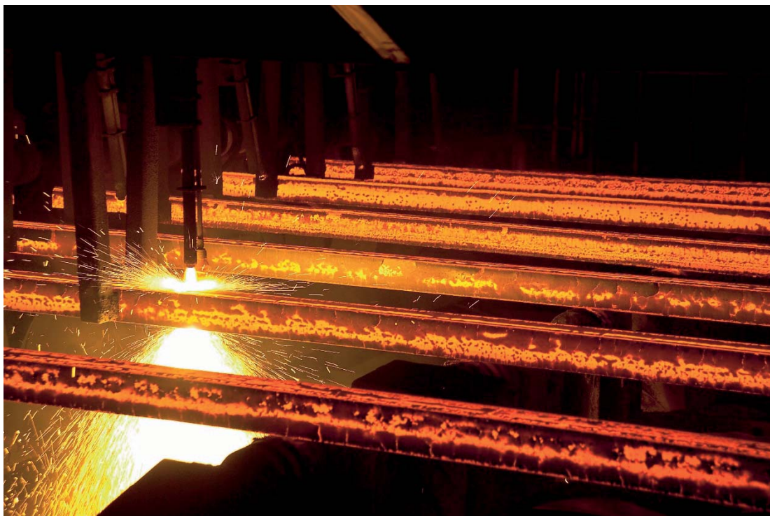
Σχήμα 2.4 Φωτογραφία συνεχούς χύτευσης και αυτόματης κοπής μπιγιετών με φλόγα οξυγόνου
